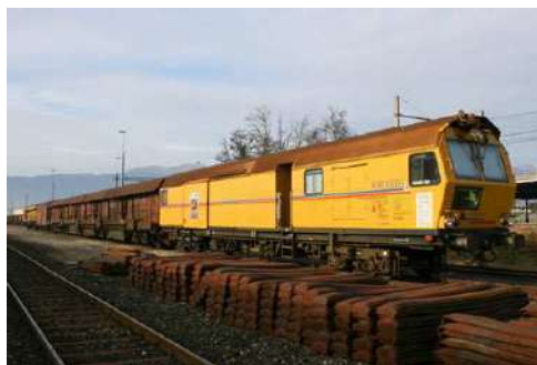
Train meuleur de rails (Scheuchzer S.A.)
